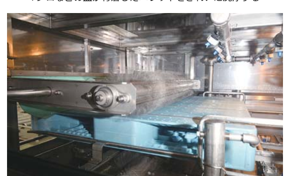
回転ブラシ(写真)と低圧多水量方式で汚れを一気に洗い流す
