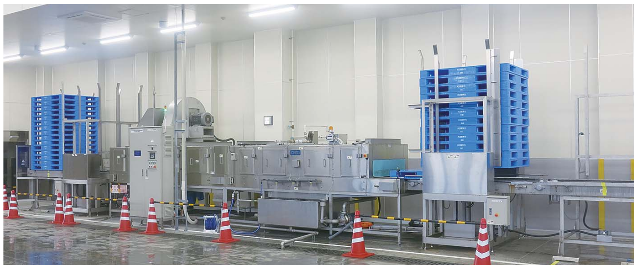
イマイユ市場に導入されたパレット洗浄機は1時間にパレット150枚の洗浄を行う仕様
