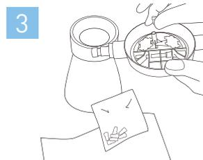
3 インジェクターの吸入口に希釈用ノズルを差し込む。
