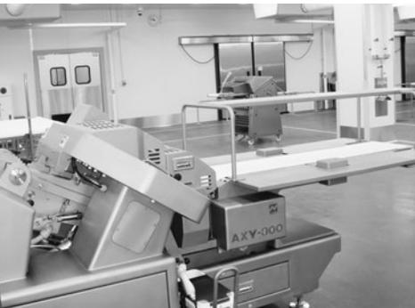
畜産加工室では、精肉の高速連続スライサーや自動折り並べスライサーなどの各種自動機器を投入、作業負担を軽減する。
