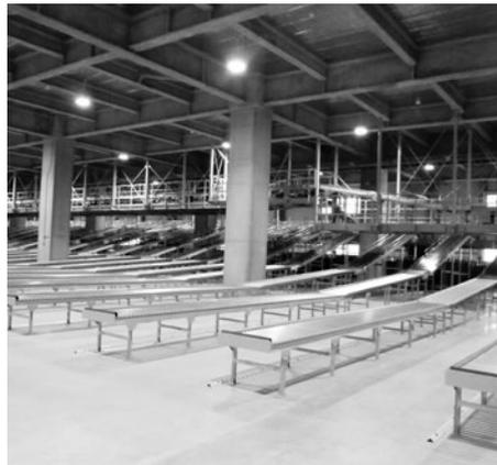
1階に設置されたケース仕分けソーター。ソーター投入商品のピッキングラベルとITFコードを照合して仕分けされ、カテゴリ別・店別の積み分けが可能になる。
