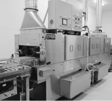
チルド入庫バスでは、標準クレート、自社クレートを大量に洗浄する洗浄脱水ラインを導入。高い生産性と省エネ、省水での環境の保全を図る。
